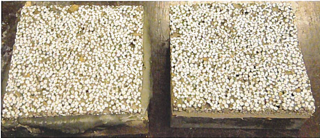
Kuva 4.3. Vetokokeissa esiintynyt murtotapa.
