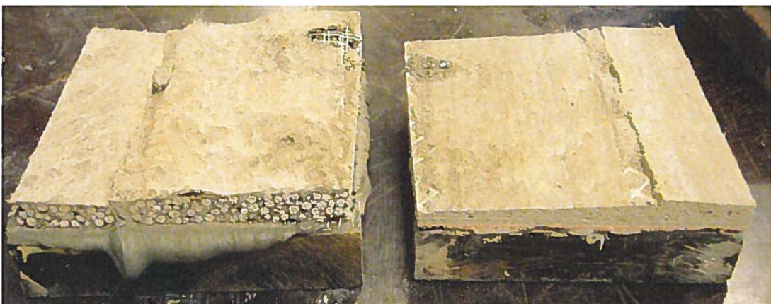
Kuva 4.4. Vetokokeissa esiintynyt yksittäinen poikkeava murtotapa.
