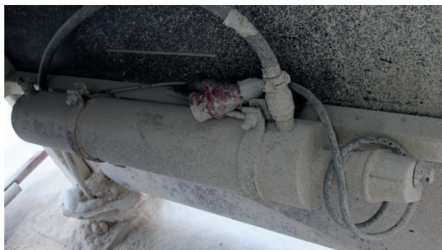
Säiliöstä lähtevä letku liitetään keskusyksikköön.
